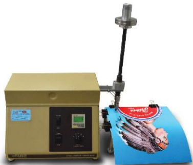
Figure 1. Les tests de rayures et d'abrasion sont effectués à l'aide d'un testeur Taber, conformément aux méthodes d'essai standard de l'industrie.
